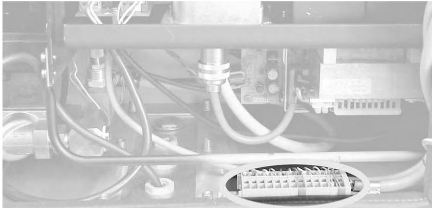
Figure 7: Position du bornier
