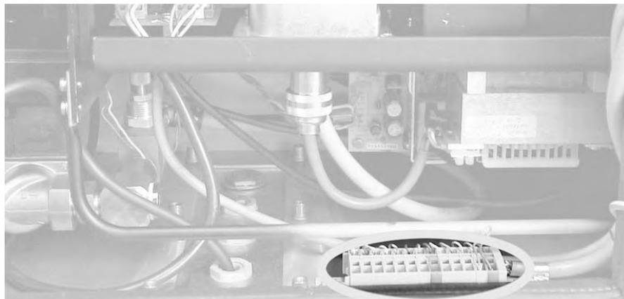
Abbildung 7: Position der Anschlussklemmen
