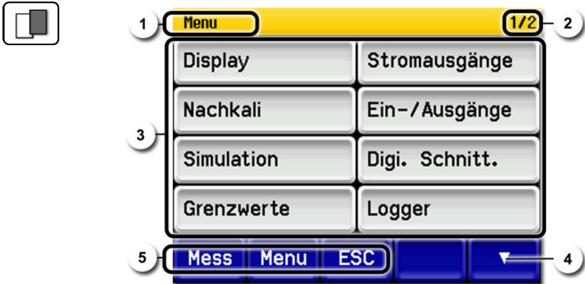
Abbildung 16: Eingabelemente im Servicebetrieb
