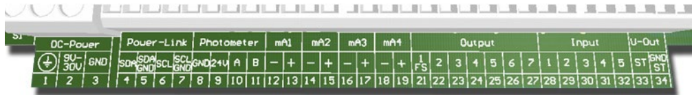
Abbildung 19: Klemmenleiste SICON (M)
