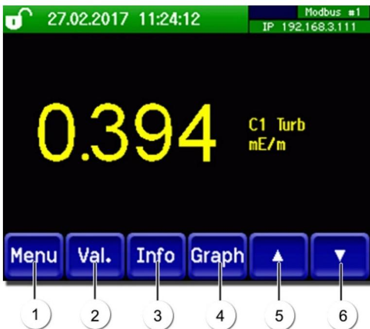
Figure 29: Éléments de commande en mode de mesure
