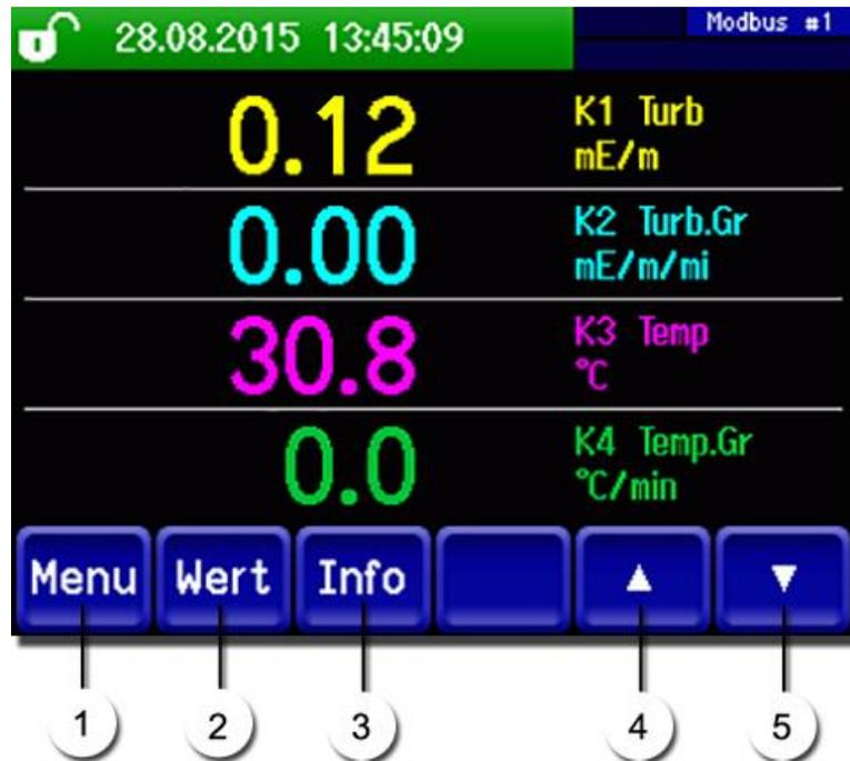
Abbildung 12: Bedienelemente im Messbetrieb
