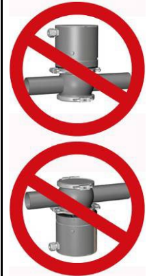
Abbildung 5: Einbau- lage falsch
