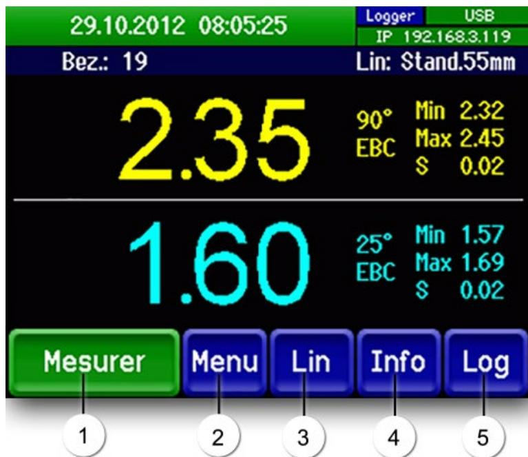
Figure 5: Éléments de maniement en service normal
