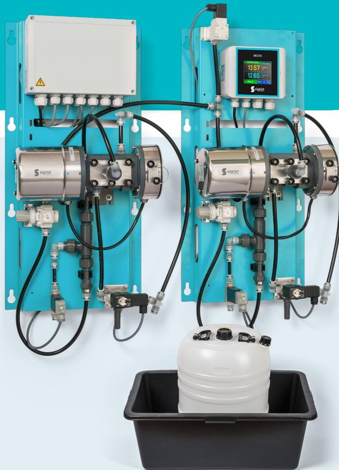
**Komplettsystem mit automatischer Reinigung zur vergleichenden Messung der UV Absorbanz (254nm) an 2 bis 4 Messpunkten**
