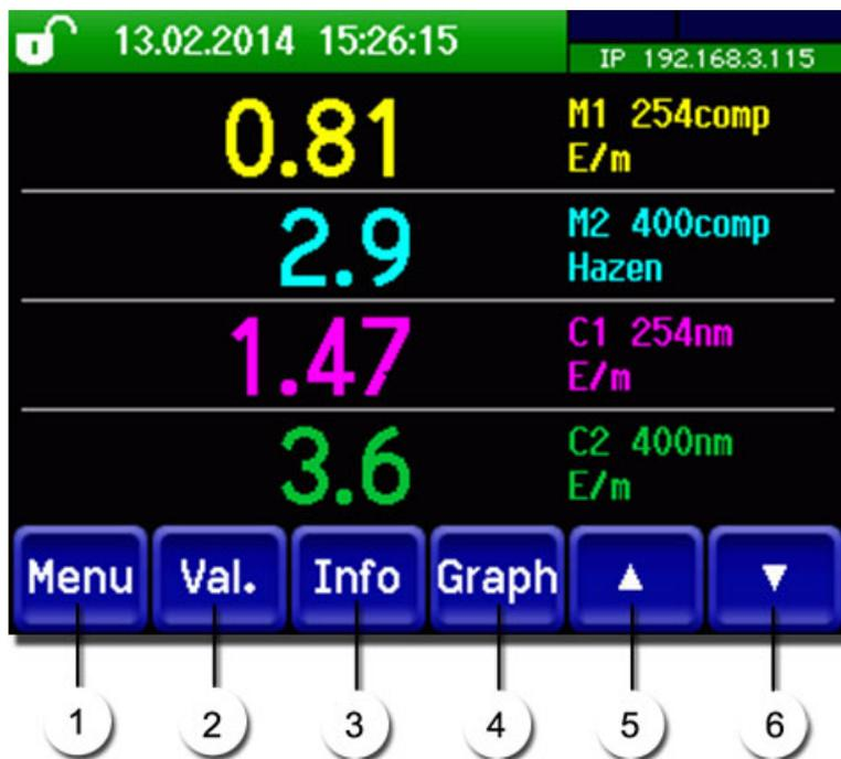
Figure 18: éléments de commande en mode mesure
