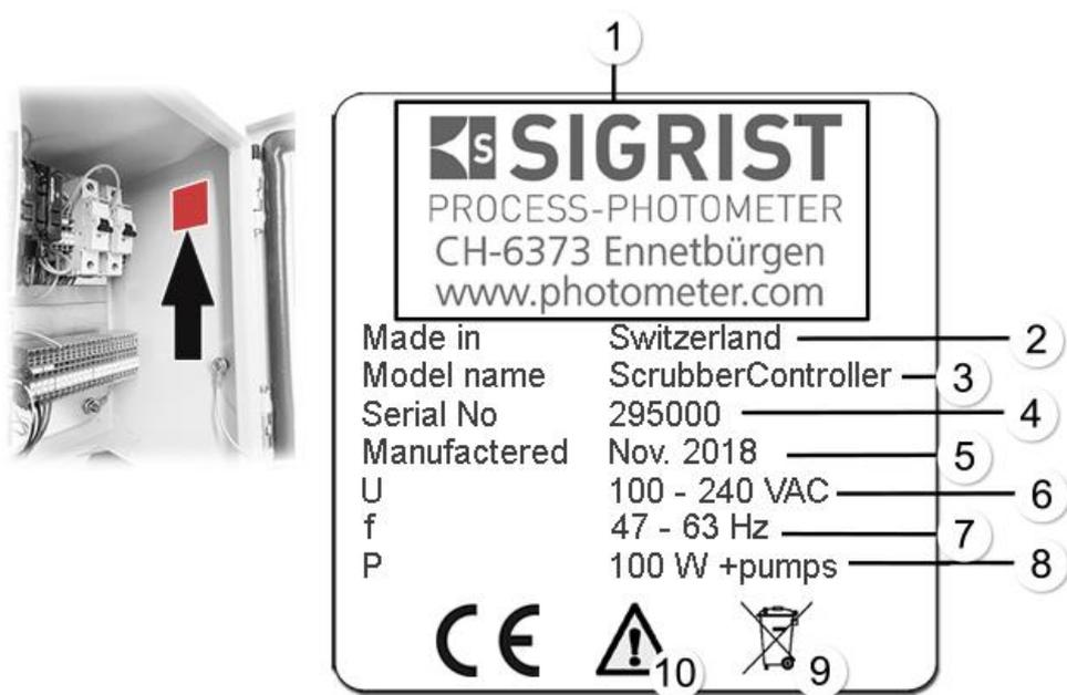
Figure 4: Identification de l'appareil ScrubberGuard
