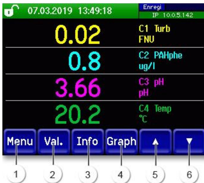
Figure 18: Éléments de commande en mode de mesure
