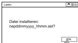
Das Gerät zeigt an welche Datei geladen wird. Der Dateiname setzt sich zusammen aus Parameter, Datum und Uhrzeit, z. B. nep210812\_2339.set. Bestätigen Sie mit OK.
