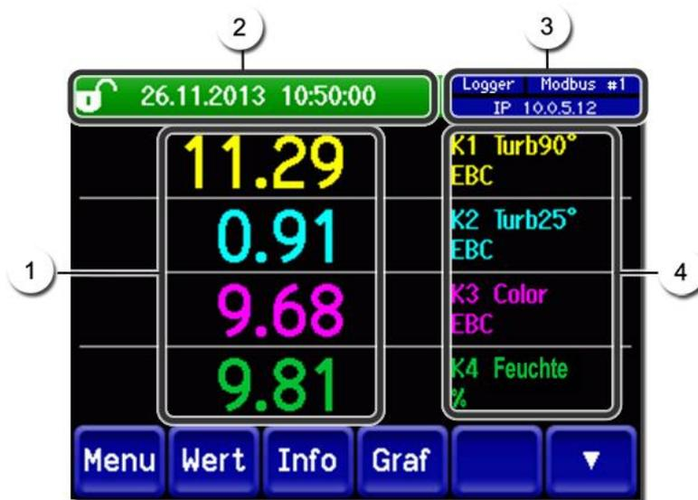
Abbildung 21: Anzeigen im Messbetrieb
