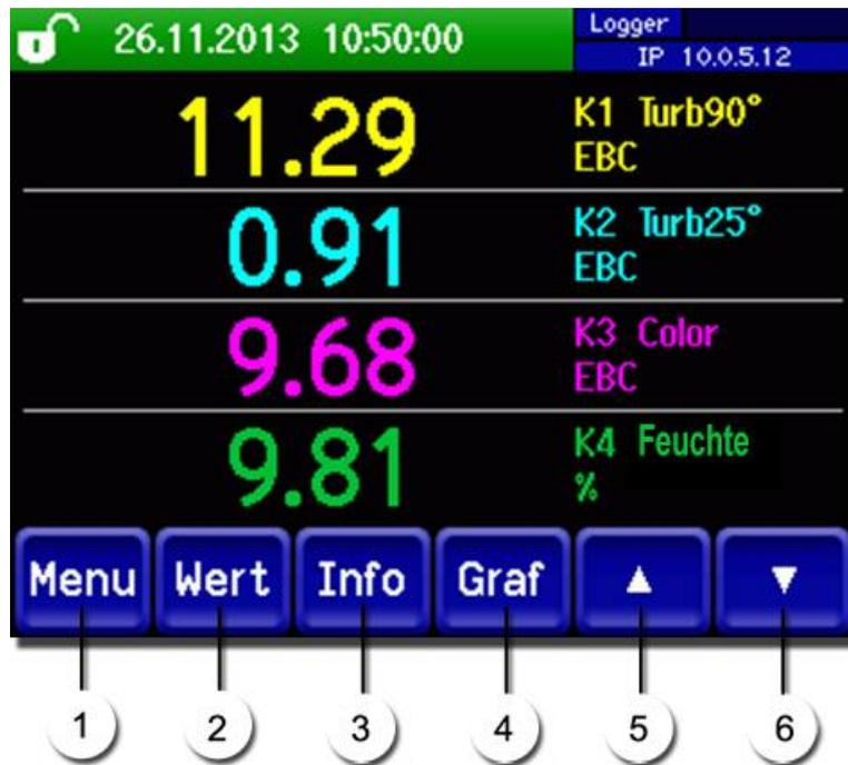
Abbildung 16: Bedienelemente im Messbetrieb
