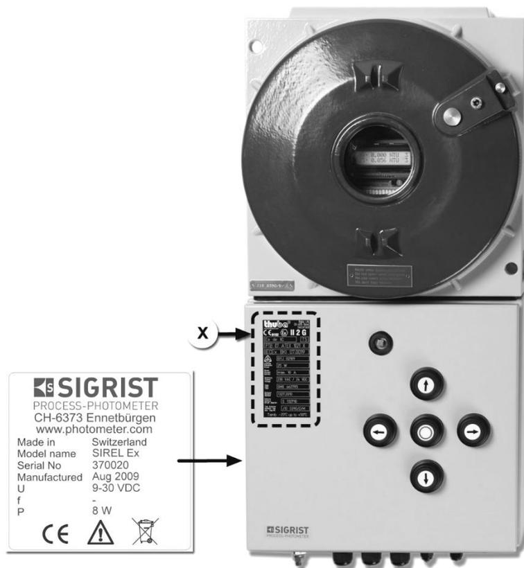
Position X: Typenschild des Herstellers (→ Betriebsanleitung SIREL Ex)
