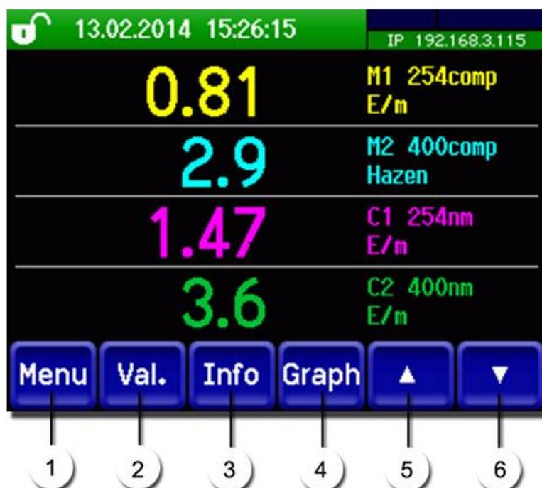
Figure 12: éléments de commande en mode mesure
