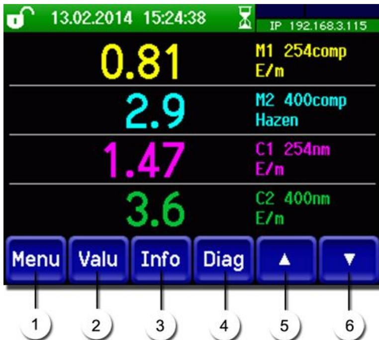
Abbildung 12: Bedienelemente im Messbetrieb
