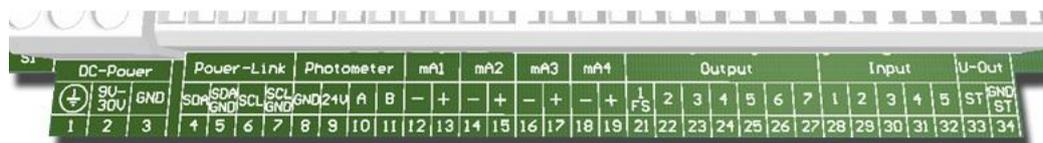
Figura 8: Bloque de terminales de la SICON
