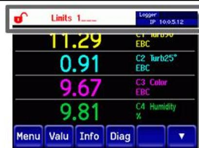
Si aparece el mensaje **limit value**, el color del estado cambia a **blanco** y los números de los valores límite de los canales que se han excedido / que no se han alcanzado se listan en rojo junto al n° de canal. Los valores límite inactivos se marcan con \_.
