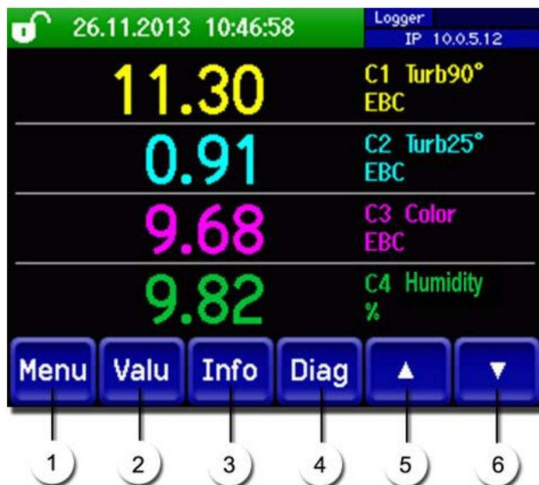
Figura 10: Componentes de control en modo normal de medida
