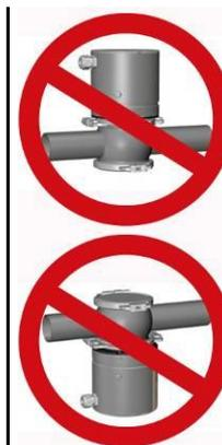
Figura 4: Posiciones de instalación incorrectas
