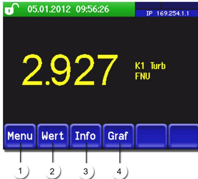
Abbildung 7: Bedienungselemente im Messbetrieb
