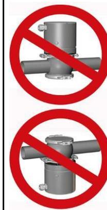
Abbildung 5: Einbaulage falsch
