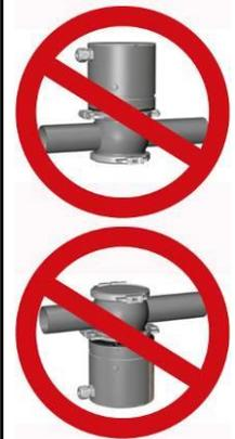
Abbildung 5: Einbaulage falsch
