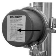
Figure 4: Plaque d'identification du photomètre.
