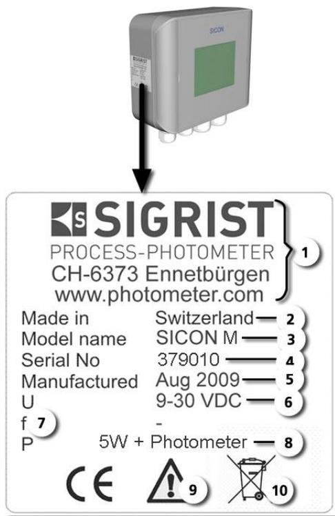
Figure 3: Plaquette d'identification du SICON M
