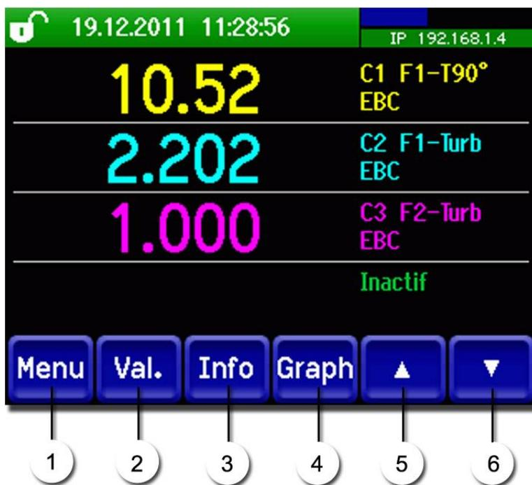
Figure 12: Éléments de maniement en service normal
