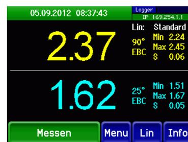
Bild 3: Messwertanzeige mit Minimum-/Maximum Werten sowie Standardabweichung
