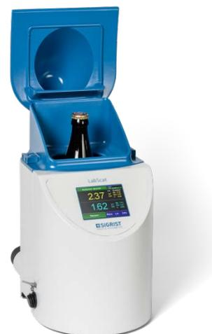
Bild 2: Gemessene Trübung in der Flasche im LabScat nach Abschluss Forciertest
