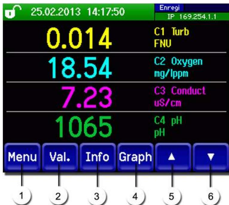
Figure 11: Éléments de commande en service de mesure
