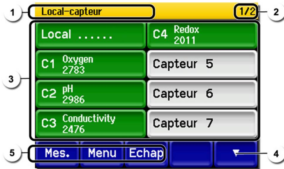
Figure 13: Éléments d'entrée en service intervention
