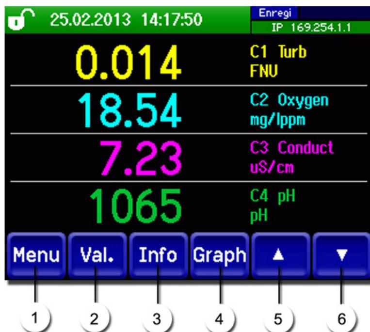
Figure 6: Éléments de commande en service de mesure
