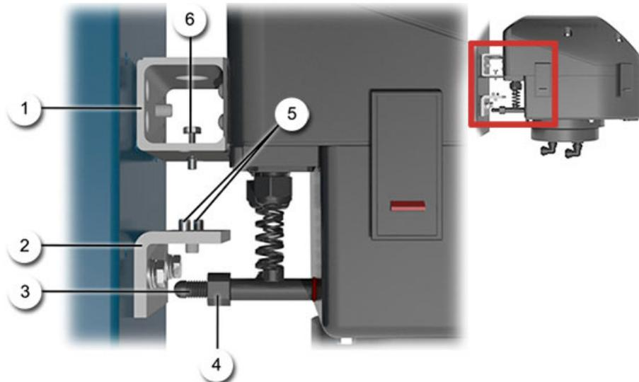
Figure 5: Montage de l'AquaMaster avec AquaScat 2 P
