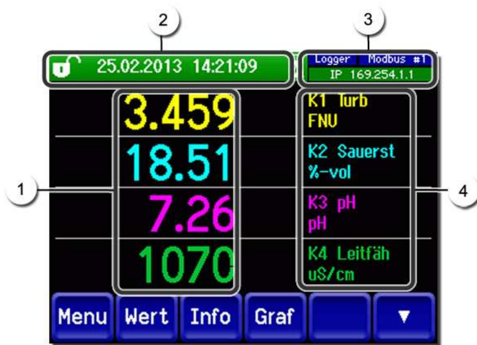
Abbildung 12: Anzeigen im Messbetrieb
