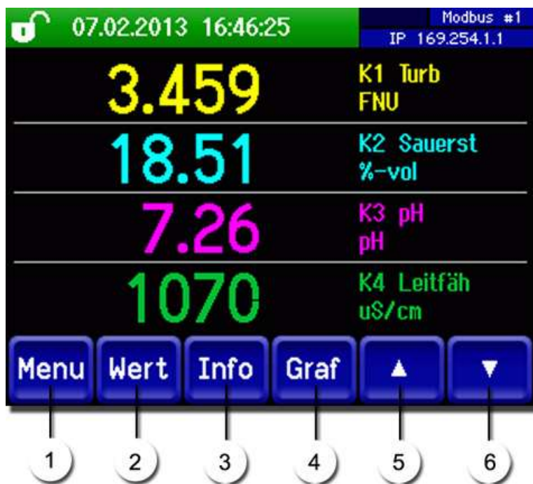
Abbildung 6: Bedienelemente im Messbetrieb
