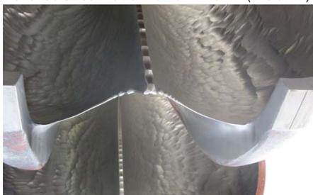
Abb. 2: Abrieb an einer Pelton-Turbine
