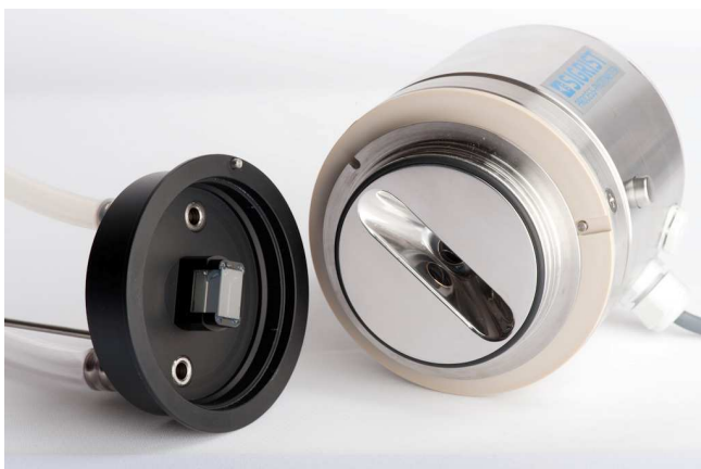
Kontrolleinheit mit Sekundärstandard und Gerät am Beispiel TurBiScat
